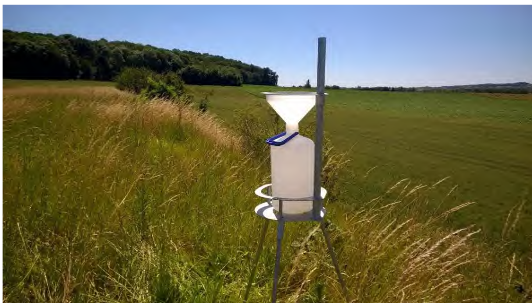
Figure 4 : Photo d'une jauge installée sur site (source : ENCEM)
